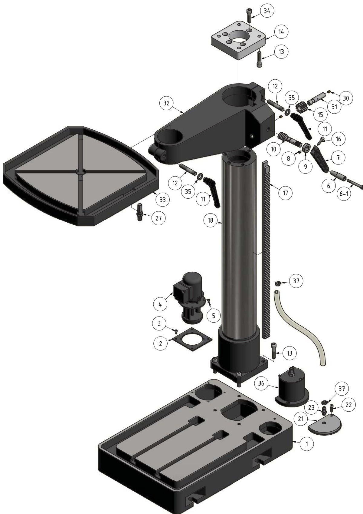
Abb.7-11: Säule und Bohrtisch - Column and drilling table
