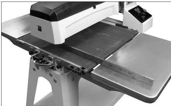
Figure 6-4: Alignement des extensions de table
