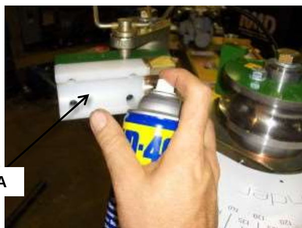
Lubricating counter die bending
